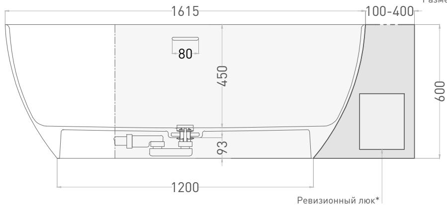
\*Размер стандартного ревизионного люка: 200x250 мм. Крепление на магнитах.
