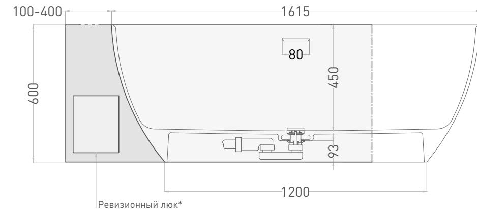
\*Размер стандартного ревизионного люка: 200x250 мм. Крепление на магнитах.
